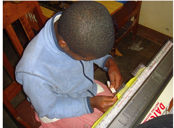
写真：編み機に櫛の歯状に装着されているのがメリヤス針
