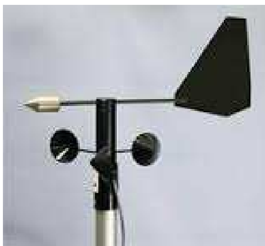
図-8 風向・風速観測機例
