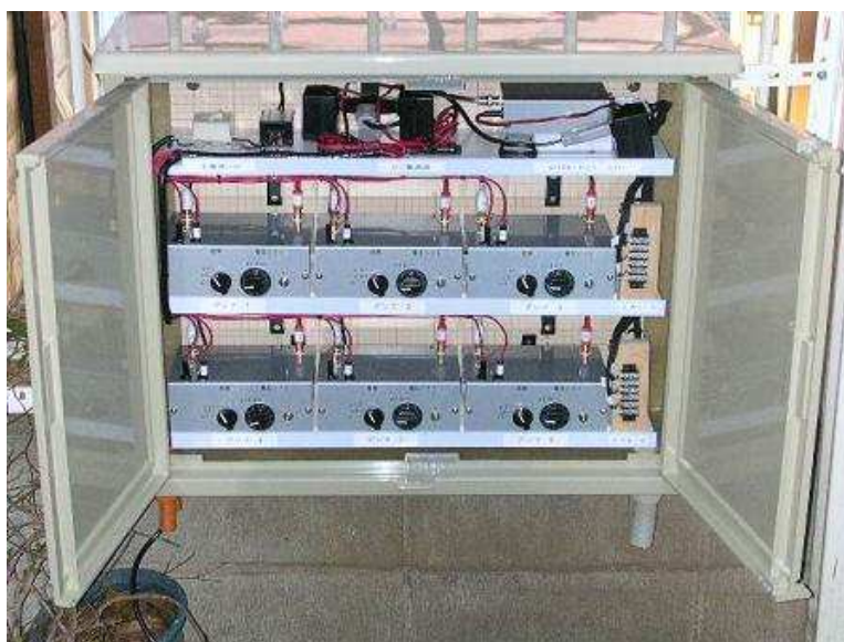
植物生体電位観測用屋外装置 前置増幅器とA/Dコンバータ
