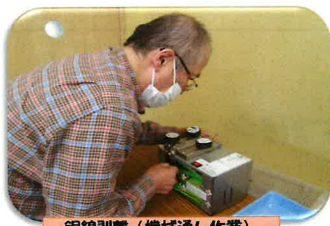
銅線剥離 (機械通し作業)
