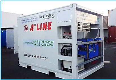
発電機付き冷凍コンテナ
