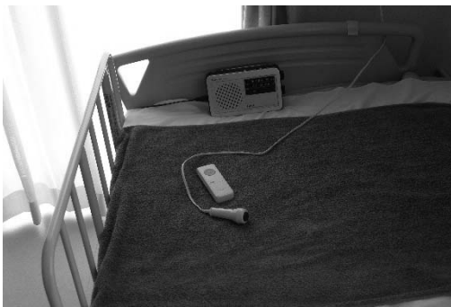
各居室に設置されているコール装置
