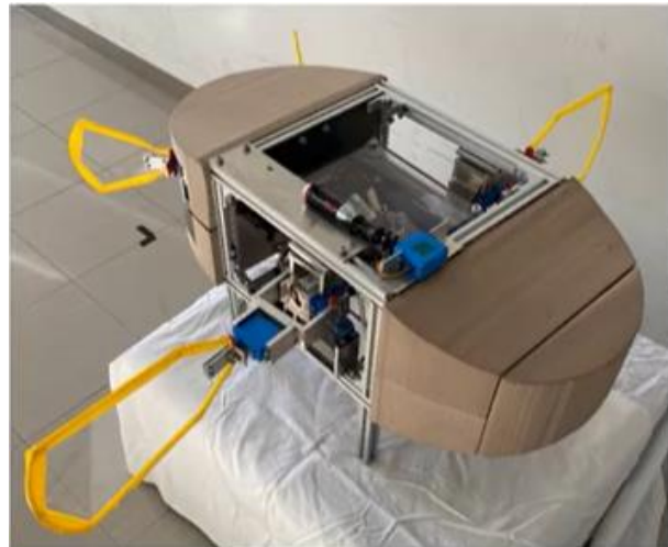
フリー部門3位の Albero (愛知工業大学 AIT 海洋チャレンジ) 抗力型の鰭で推進します
