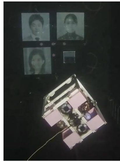
AI チャレンジ部門で優勝した ARIEL (東京大学巻研究室) マスクをしていない人を自動判別して、マスクを置いてくるロボット
