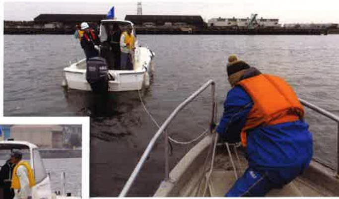
曳航索の取り付け作業
