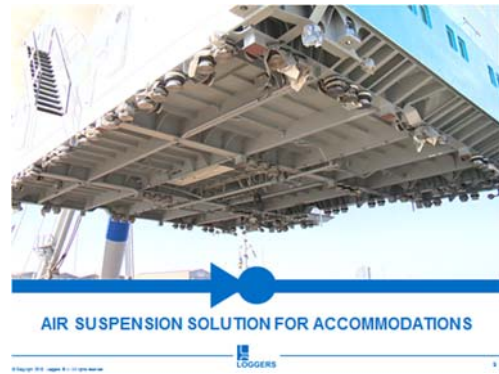
Loggers 社の空気圧式騒音・振動低減支持装置
