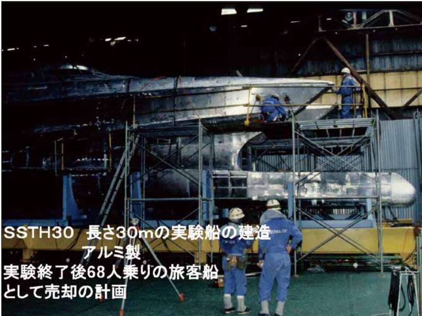
SSTH30 長さ30mの実験船の建造
