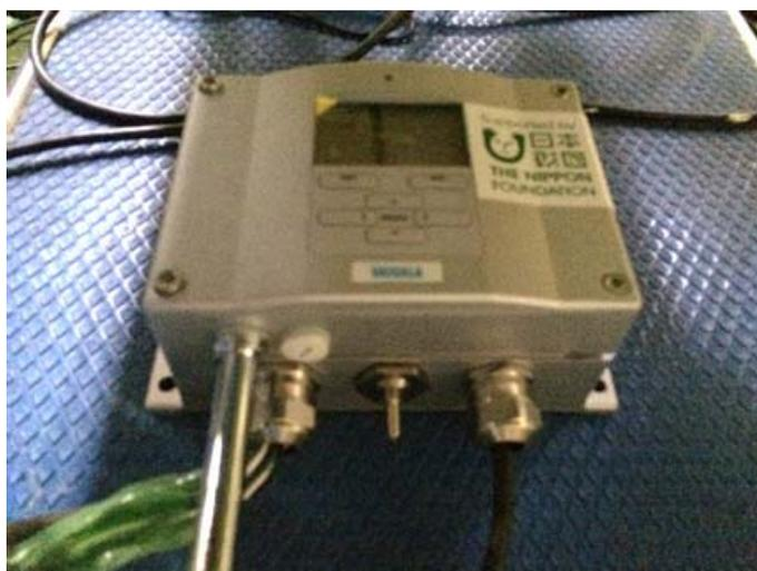
図 2-1-2-6 大気圧気温湿度変換器
