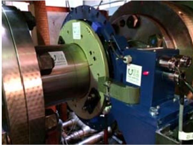
図 2-1-2-9 軸馬力計取付け
