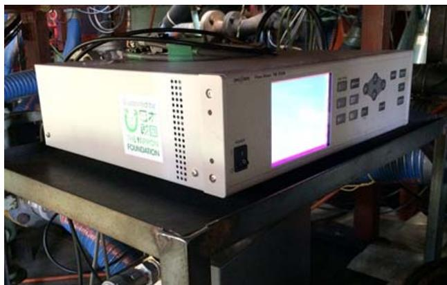
図 2-1-2-3 燃料油流量計(表示部)
