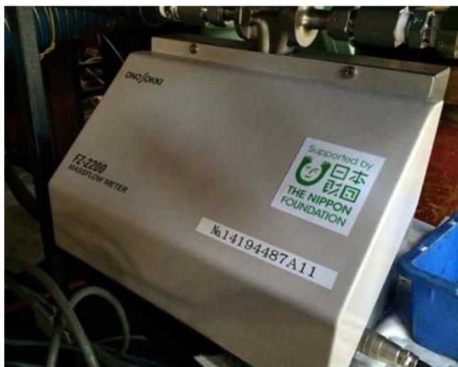
図 2-1-2-2 燃料油流量計(センサー部)
