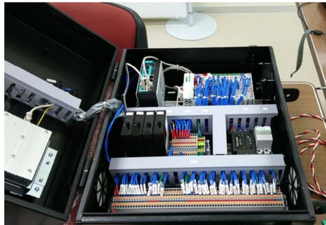
図 2-2-2-1 データ計測・収集ユニット外観
