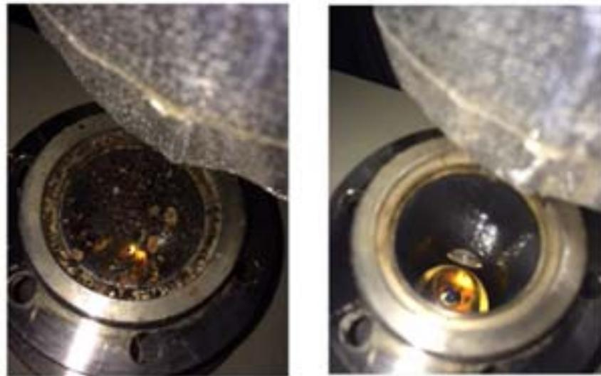
図 7 1. 排ガスにより窓板が汚染した様子（左）および清掃により回復した様子（右）
