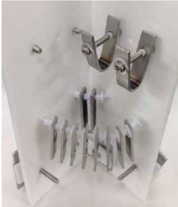
図 3 8 . 試験片のジグ固定状況
