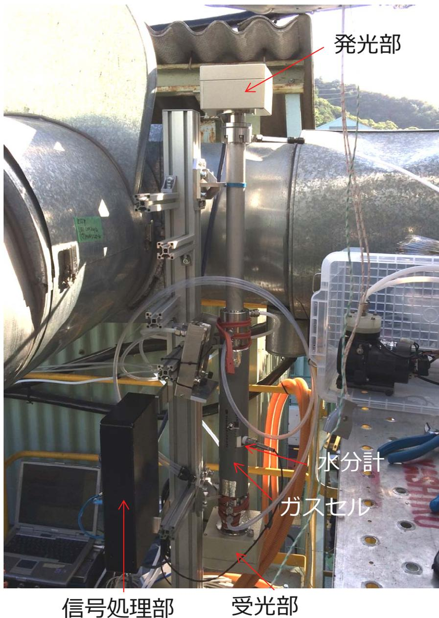
図 7 6. 陸上試験におけるレーザ式分析計の状況
