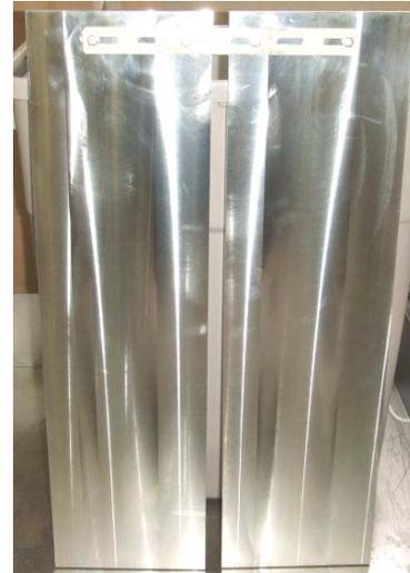
図 5 9 . マグネシウム電極の外観
