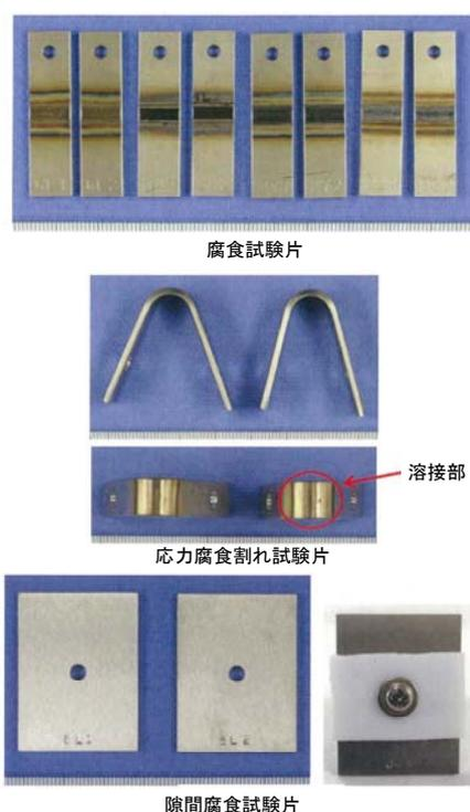
図 3 6. 各試験片の外観一例
