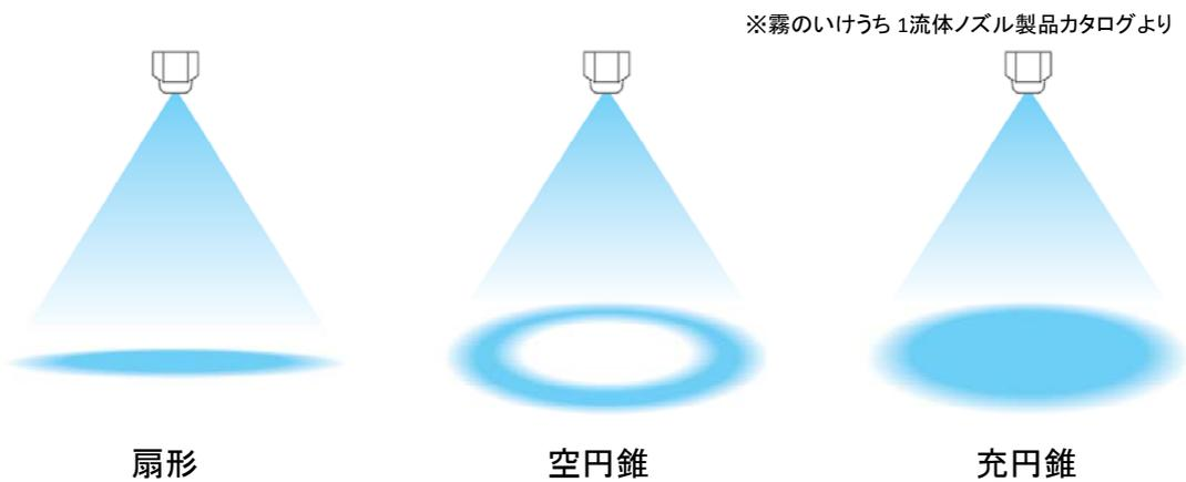
図 2 8. スプレーノズルの噴霧パターン (例)
