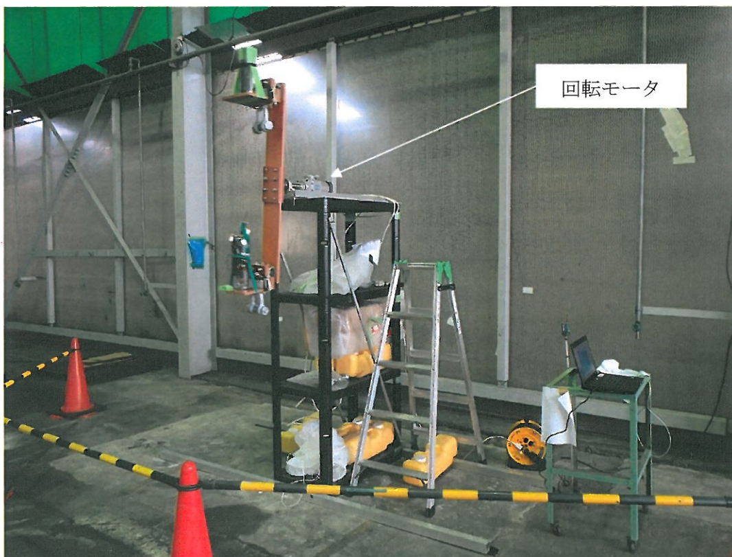
写真 10. 波高センサーパッケージの性能試験
