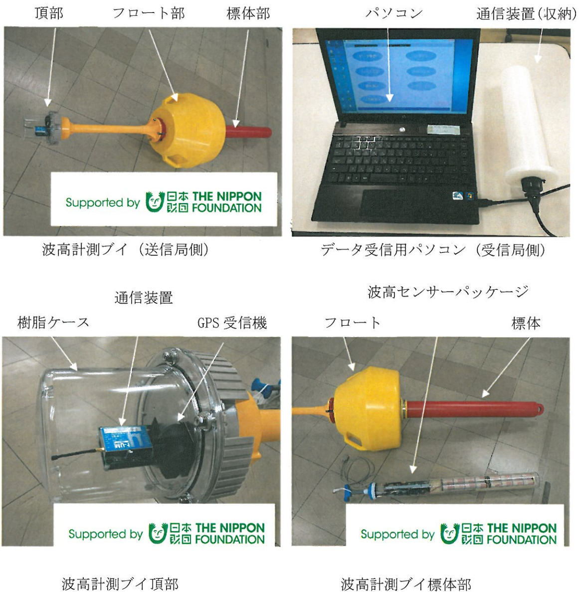
写真 9. 波高計測装置試作
