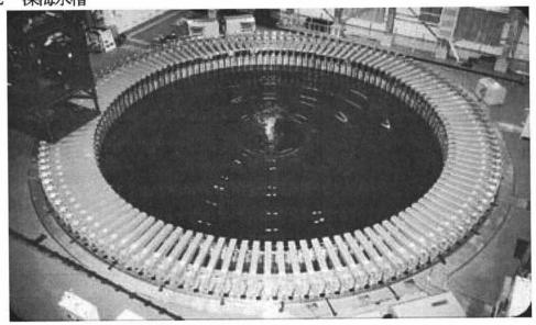
直径 16m、深さ 5mの円形水槽の中心に直径 6m、深さ 30mの深海ピットがあり、最大深度 35mの世界第 2位の深さを持つ水槽である。円形水槽全周を 128 台の造波装置が取り囲んでおり、実海域を模擬した多様な波を再現することが可能である。残念ながら工事のため水が入っていなかったが、集中波やメッシュ状の波等、各種の造波の模様を撮影したビデオが興味を引いたようである。海洋掘削関連の質問も多数でていた。
