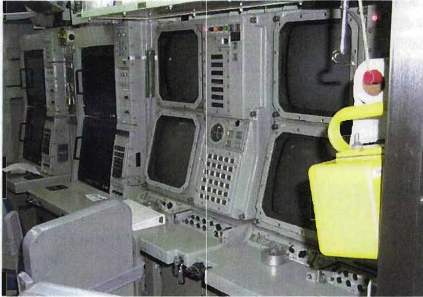
図5. 各ソナーワークステーション、スタックには二つのモニターがあった。右側の表示システムの二つのスタックは艦に取り付けられた装置から入力される。(U.S. Navy photo)
