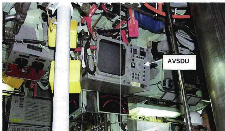
図4. アナログ式信号映像表示モニター、AVSDUは、 Greenville の潜望鏡台の近くに設置されているソナーリピータであった。事故当日、AVSDUは作動していなかった。(U.S. Navy photo)
