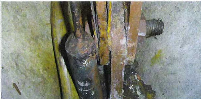
図 18：右舷側救命艇における艇首側フックのキール連結部
