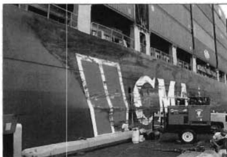
図3：衝突による「ヴィル・ドリオン号」の損傷
