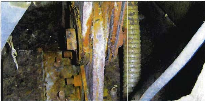
図 18：右舷側救命艇における艇首側フックのキール連結部
