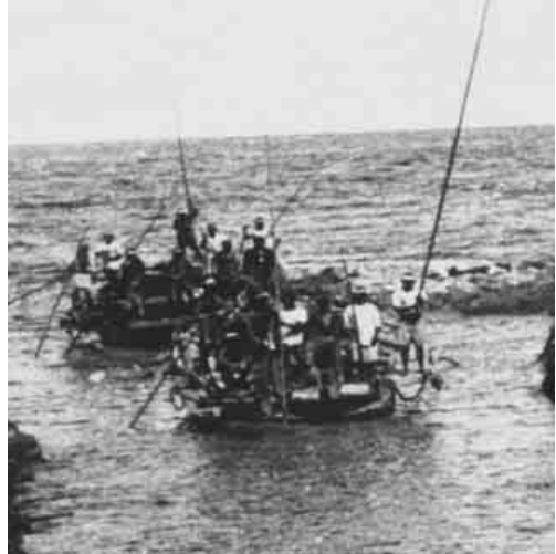
艫を前にして、棹さして船を進めている。舵とペラ上げれば、水深 6、70センチでも航行できる。
