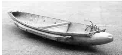
燃料タンクを 2 つに切って、エサ採りのサバニ代用で使った。（「甦る沖縄」より）
