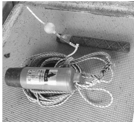
撃退用のおどし玉(上)と超音波発生装置(下)。この2つを使えば、イルカ撃退には効果がある。
