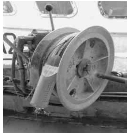
釣器：左は駆動装置、太鼓に幹繩のワイヤーが巻かれ、撒きエサ袋が見える。
