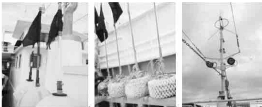
左：ダルマ灯、旗の先端に電灯を縛る。中央：ラジオブイ。右：ラジオブイの位置を探す方向探知機。
