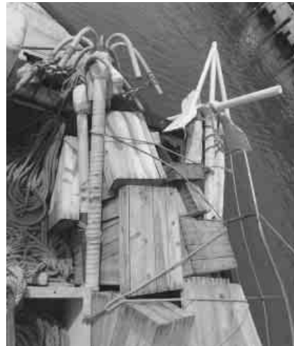
右：唐人アンカー（主に港での係留用）、 左：手製の爪付きアンカー（漁場で使用）
