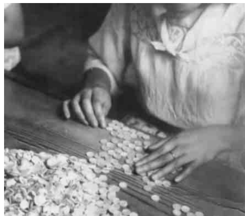
くりぬいてできた貝ボタン。でき具合を選別している作業光景。(「奈良県中和地区商工会」より)
