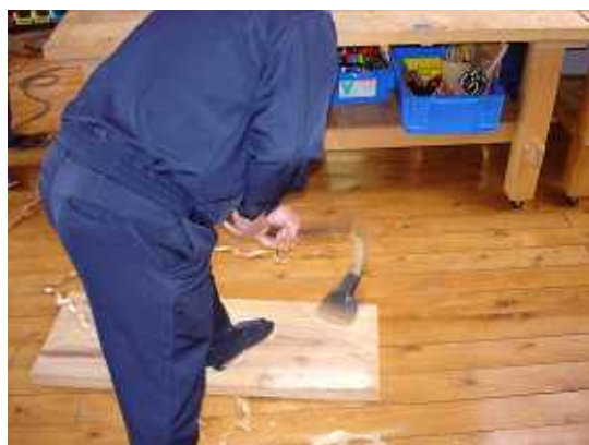
写真 30：直井光男棟梁による手斧（鑿・チョウナ）と槍鉋（ヤリガンナ）の実演
