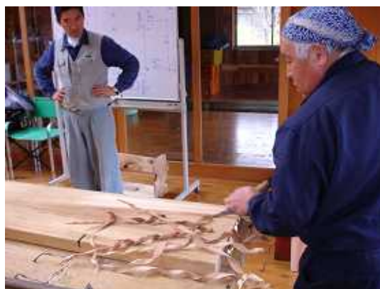
写真 30：直井光男棟梁による手斧（鑿・チョウナ）と槍鉋（ヤリガンナ）の実演
