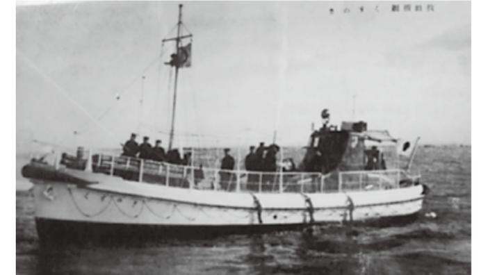
※昭和10年9月に大阪救難所に配属され使用されていた西洋型鋼製船の救助船「くすのぎ」。この当時から探照灯、各種救助器具、投網銃を搭載
