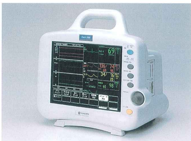
携帯モニター（DASH3000サイズ：28B×26H×20Dcm）
