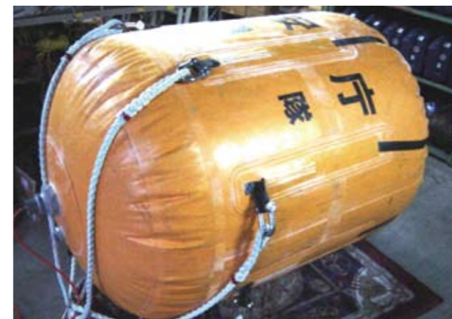
アクアリフター 3トンの浮力体(直径約1.5m、長さ2mの円柱形)で、 沈下の防止措置のため転覆船等に取り付けるものです。 潜水ポンプから圧縮空気を注入することで膨らませます。
