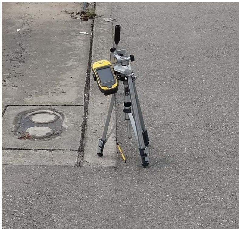
図 9.9 GE07X 本体に三脚を取付けた際の様子 (地点 J-11 観測時)
