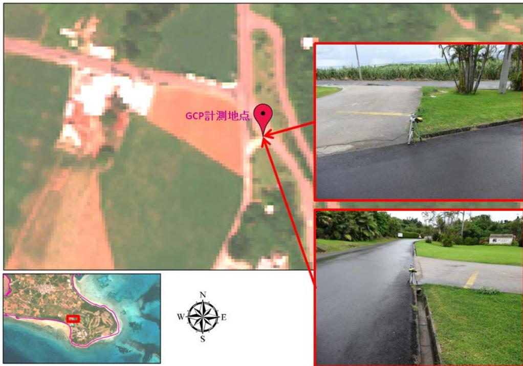
図 9.8 GCP 計測地点と衛星画像上の対応点
