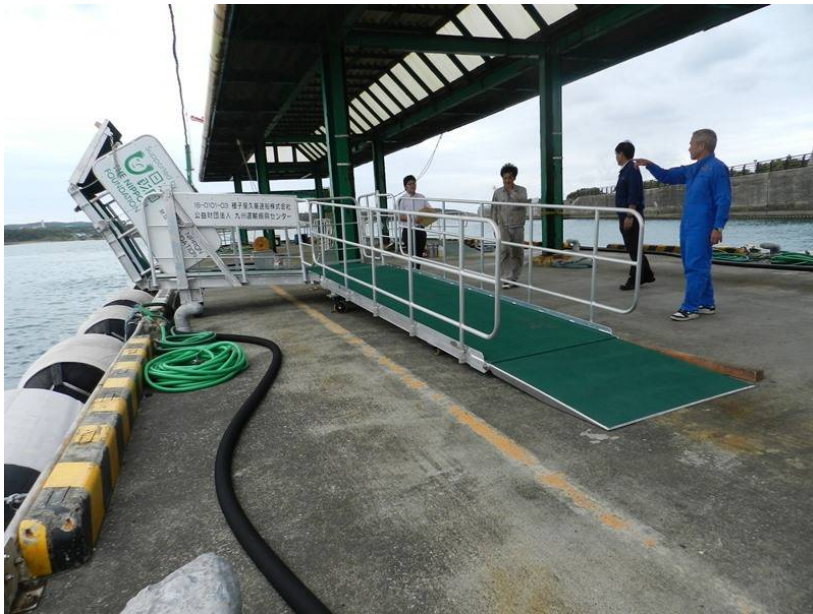
バリアフリー対応型タラップ 種子屋久高速船(株)向け 1基 L5500×W1100×H556 mm
