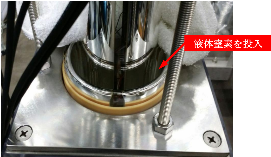
図 2 6 . クライオスタット外側に設けられた断熱層
