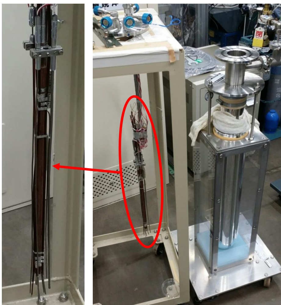
図23. 温度センサの取付け
