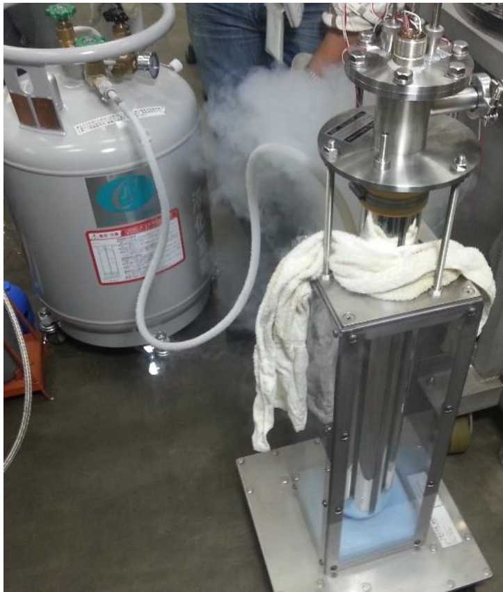
図 2 7 . 液体窒素によるクライオスタットの予冷
