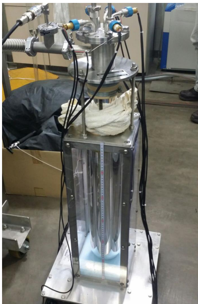
図 2 5. クライオスタット(温度センサは内部に設置)
