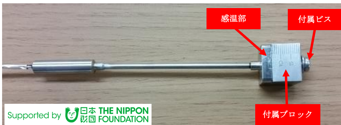
図 7 4. 表面温度計測用センサの評価状態
