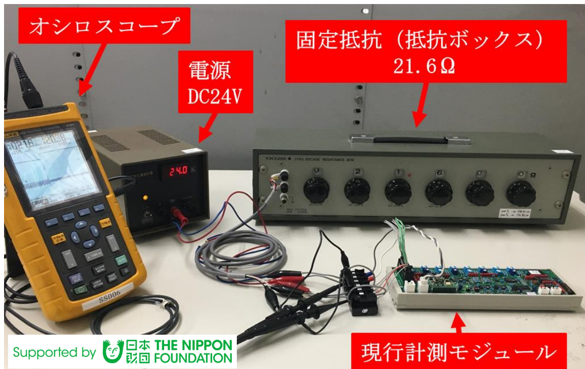
図42. 突入電流計測の回路構成概要
