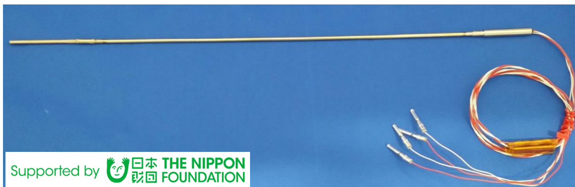
図 5 8 . No. 1 インタンク用高精度温度センサ外観(導体部長 350mm)
