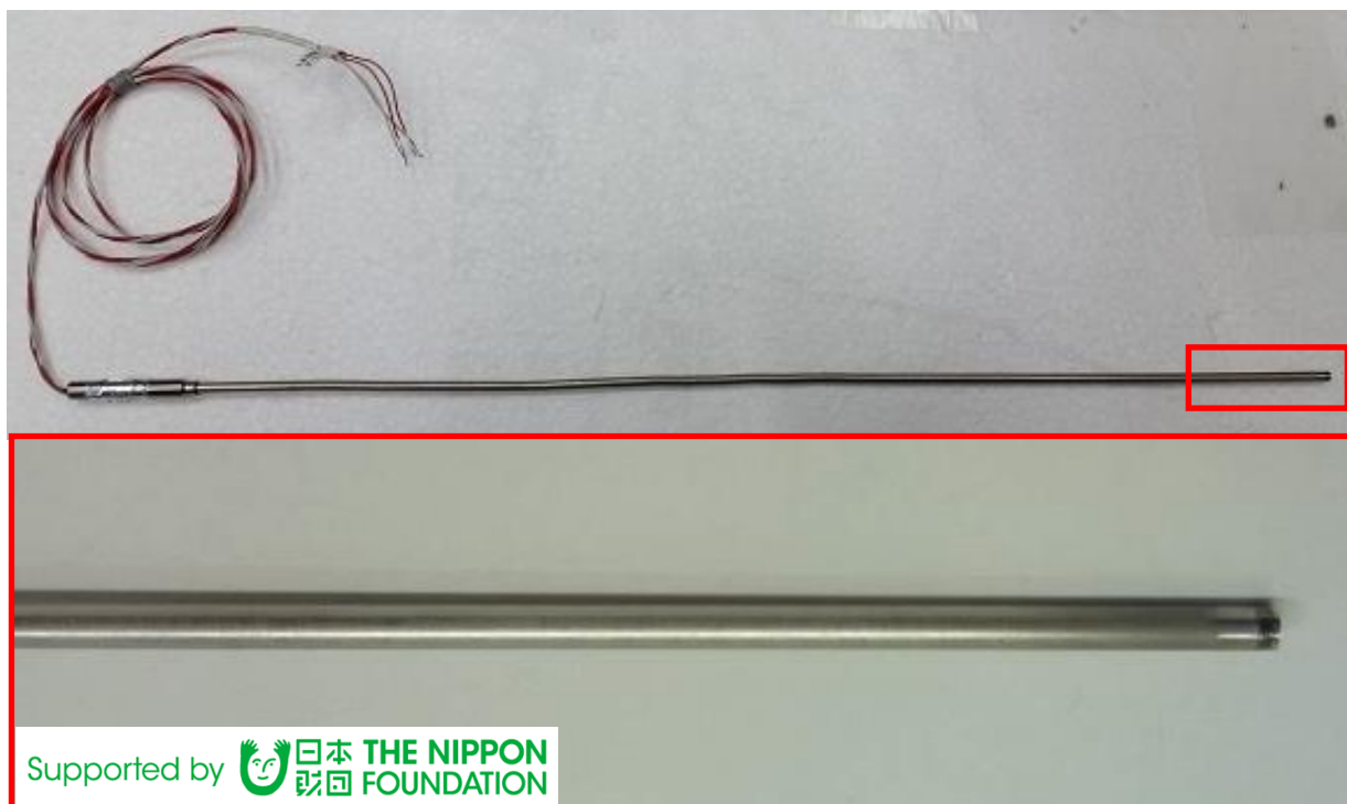
図 1 3. \Phi 3.2\text{mm} 性能評価試験用センサ外観 (感温部及び導体部外径 \Phi 3.2\text{mm} のシース测温抵抗体：導体部長さ 350mm)
