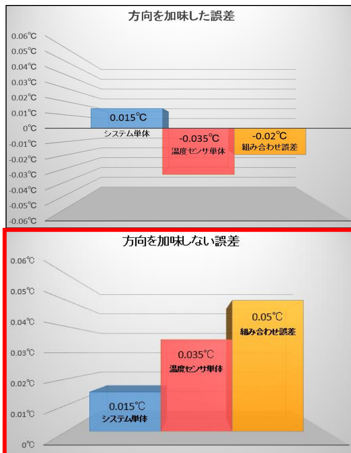
図 1 1 1 . 各機器単体の誤差と組み合わせ誤差の概要
