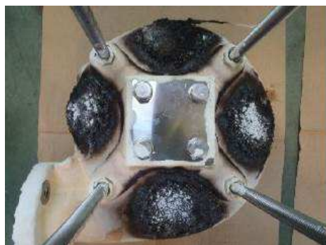
(a) 耐火試験完了後底面
