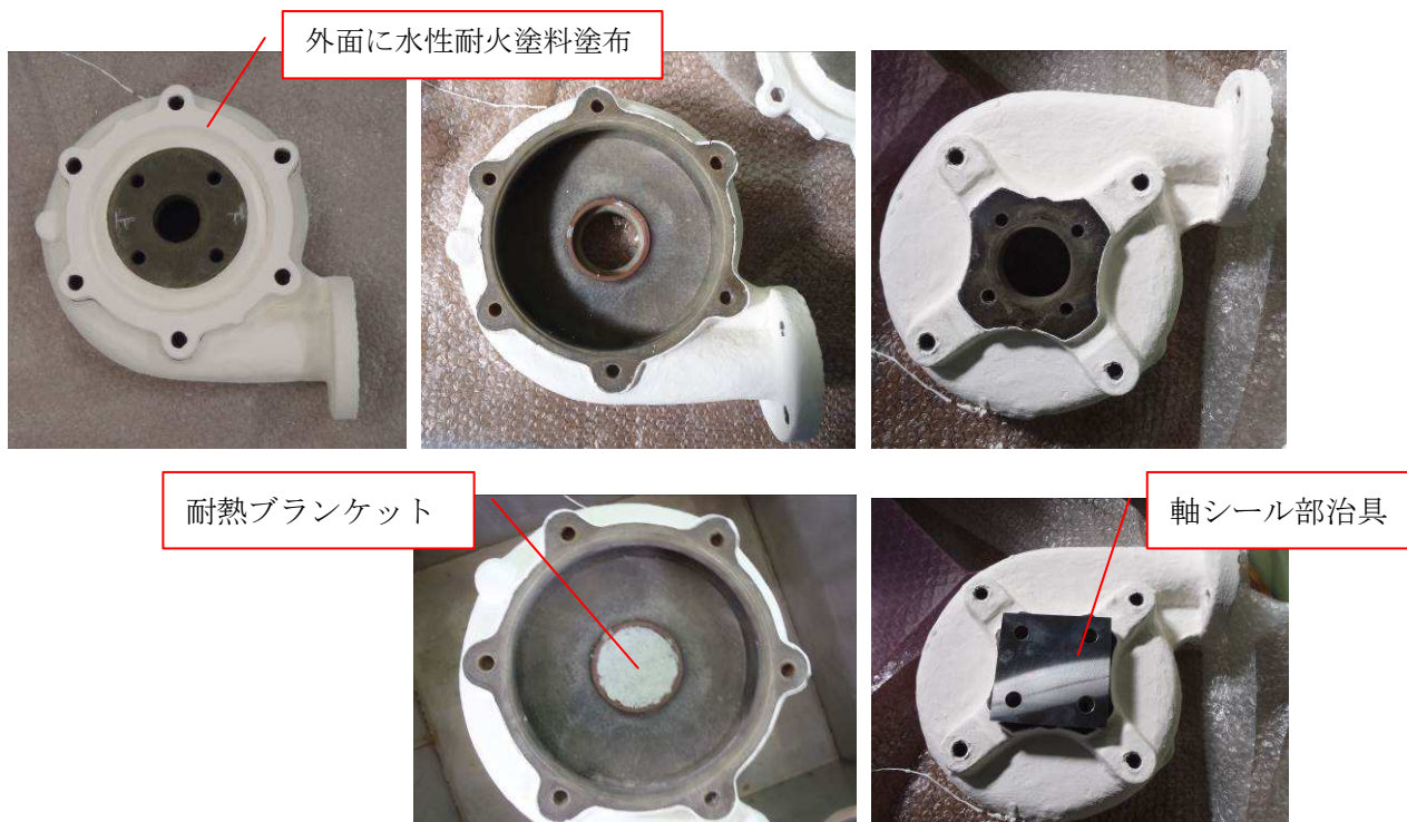
図 4. 4. 6. 3 ポンプケーシング（試験前）
