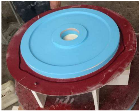
図 4.3.4.2 ケーシングカバー 現型および下型
