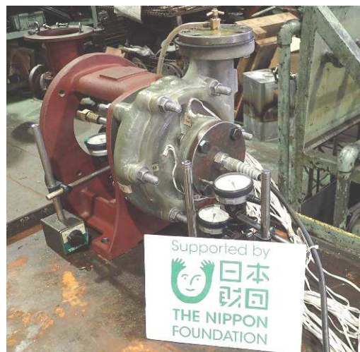
(a) 供試体取付状況
