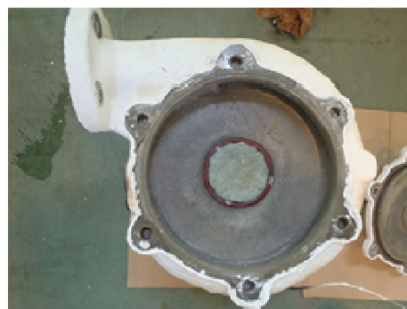
(b) 耐火試験完了後内面
