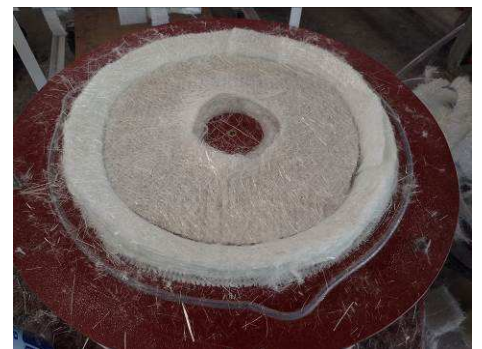
図 4.3.4.5 ケーシングカバーの型に ガラス繊維をセット
