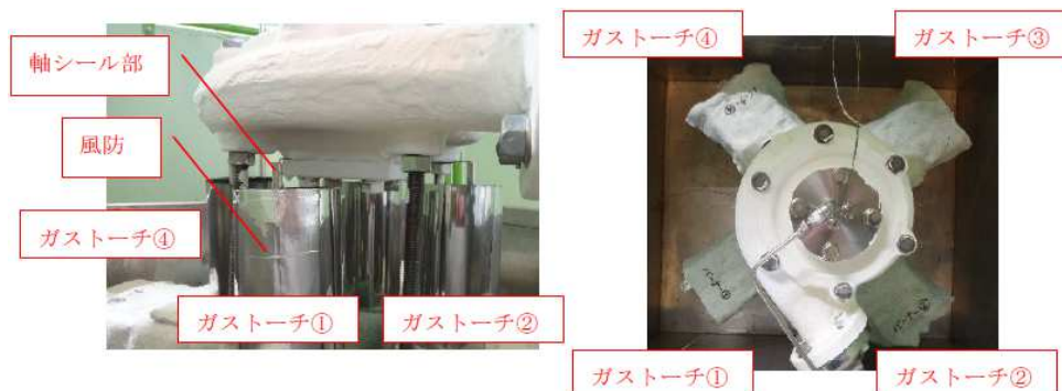
図 4.4.6.6 耐火試験時ガストーチ設置状況
