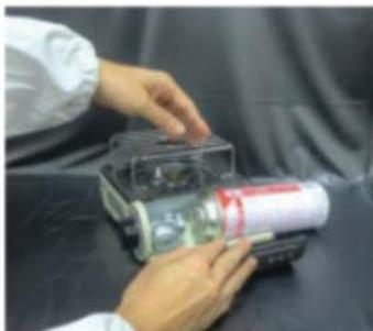
カセットガスをカセットガスコンロにセットします。
