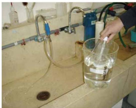
水流ポンプからの、水を吸引する管に取り付けたピペットを、ペットボトルの中に入れ、海水を吸い出します。2リットル吸い出し、1リットル残します。
