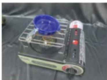
蒸発皿の下にアルミ箔で作った枕（太さ1センチ程度の棒）を敷き、蒸発皿を傾けてガスコンロに置きます。
