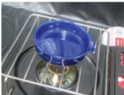
1分あまりが経過すると、蒸発皿の一部が写真のように干上がってきます。このような状態になれば、火力をさらに落とします。
