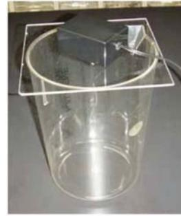
注) 水替えなどでモーターを止めてビーカーから外すときに、羽根をつけたままモーターを裏返しにしないでください。羽根から軸を伝って海水がモーターに入り、モーターがダメになります。羽根を付けたまま置きたいときは、横向きにしてください。
