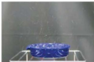
干上がる直前、乾固した結晶が激しく飛び散ります。これは、結晶の下に残った水分が水蒸気となる際に体積が増加し、結晶を吹き飛ばすためです。
