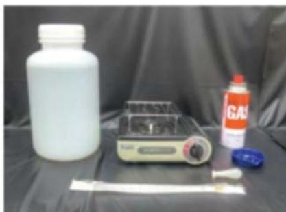
カセットガスコンロ、カセットガス、蒸発皿、メスピペット、ゴム球、海水
