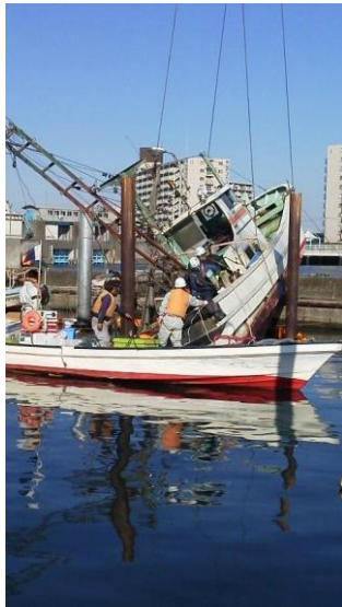
乗り上げた船をクレーンを使って元に戻す。 幸い水に浮いた
