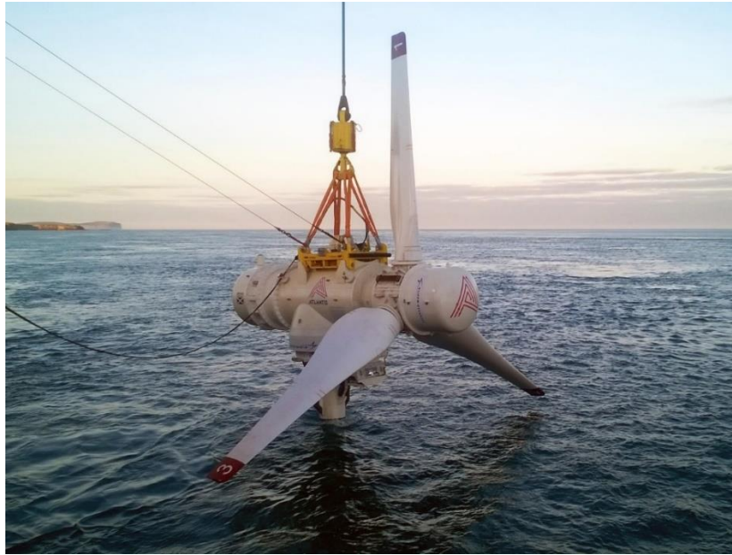
図 14 アトランティス社の潮流発電装置
