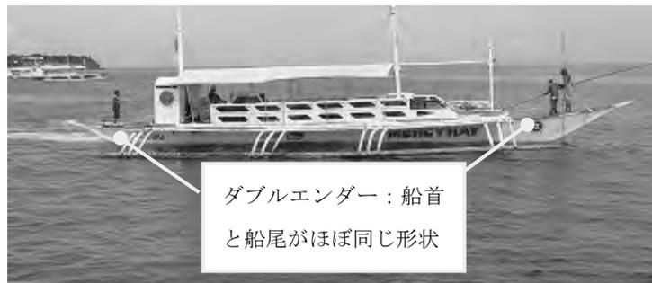
図 33 ダブルエンダーの排水量型船型
