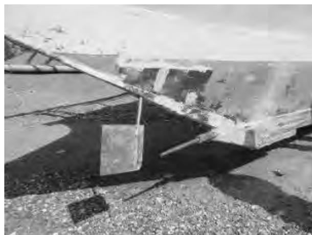
図 35 バンカボートの舵・プロペラ
