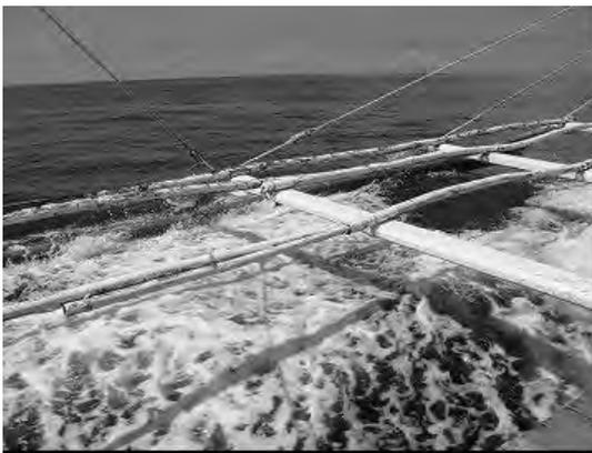
図 38 波に刺さる構造
