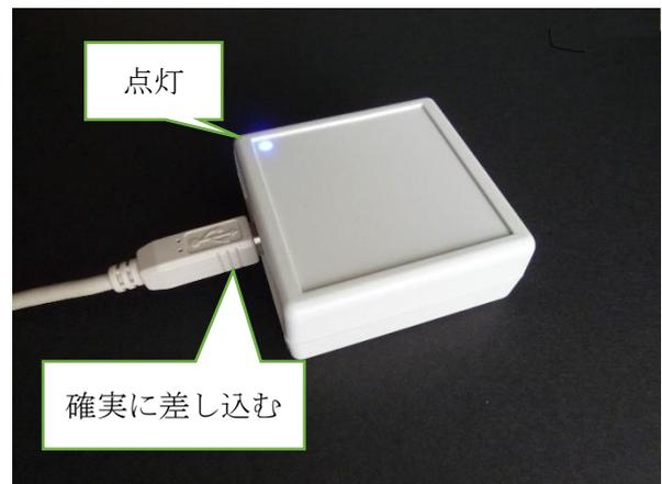
図 3.スイッチボックスの差込口
