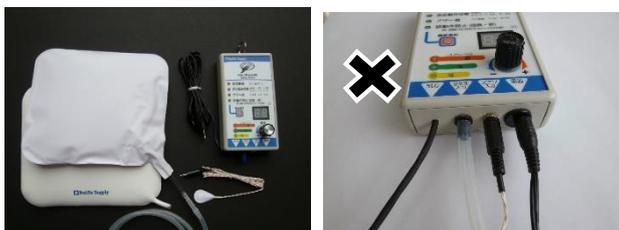
エアバッグ・センサーとピエゾ・センサーの2のセンサーを接続して(右)使用するのはNG。
