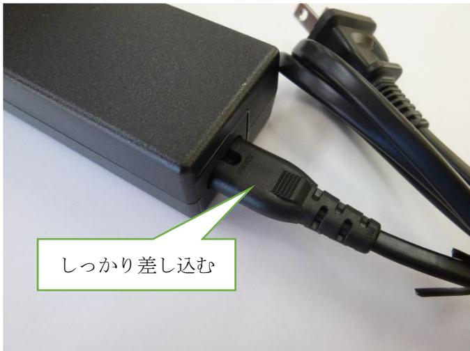
図 11.ACアダプタの差込み
