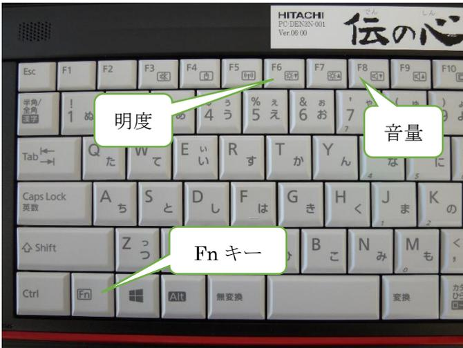
図 25.明るさ、音量の微調整
