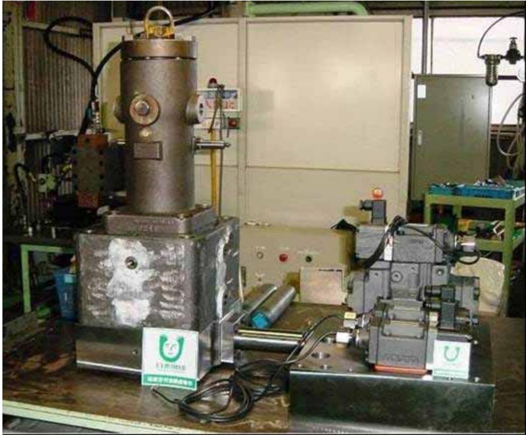
・ 吸排気弁駆動用サーボ弁
