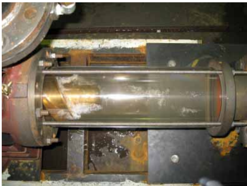
図 6.4.4.5 温水高速新形状 3次元羽根車および TYPE9 組み合わせ可視化 5 ( Q=30\text{m}^3/\text{h} )
