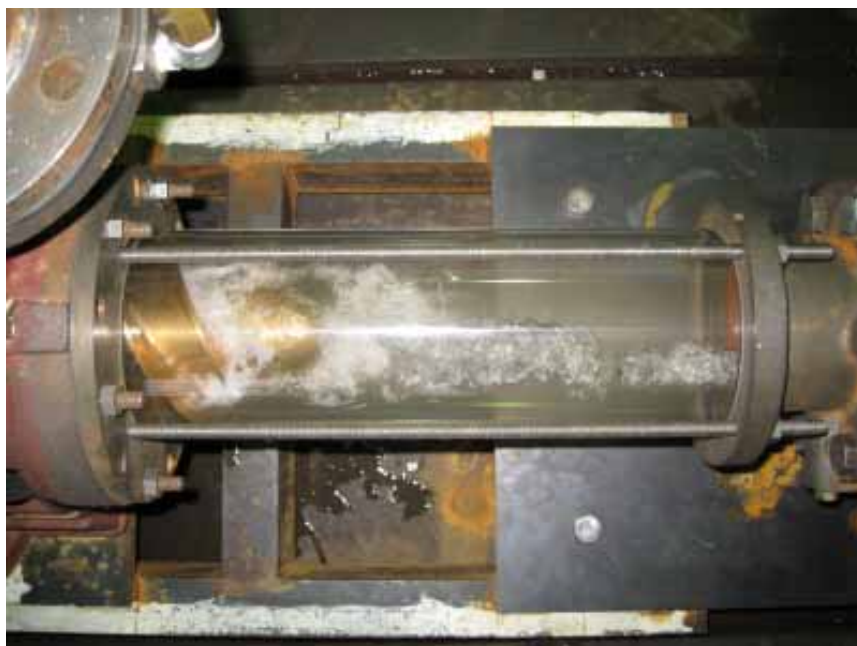
図 6.4.4.1 温水高速新形状 3 次元羽根車および TYPE9 組み合わせ可視化 1 ( Q=15\text{m}^3/\text{h} )
