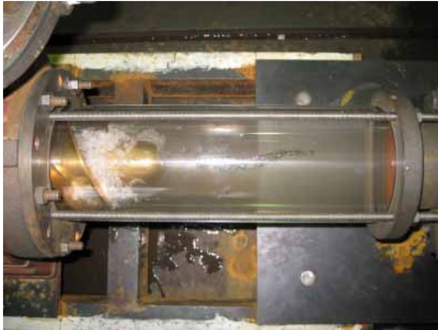
図 6.4.4.3 温水高速新形状 3次元羽根車および TYPE9 組み合わせ可視化 3 ( Q=25\text{m}^3/\text{h} )
