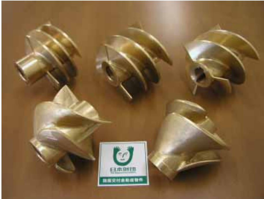
写真 5.2.3 予圧羽根車外形写真 [上段左より TYPE1,2,3 下段左より TYPE4,5]
