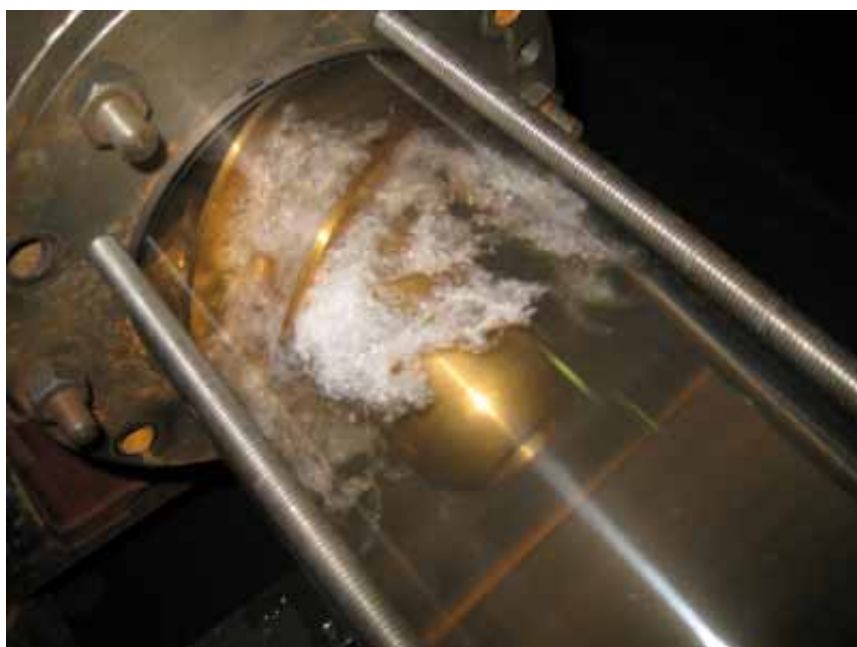
図 6.4.4.8 温水高速新形状 3次元羽根車および TYPE9 組み合わせ可視化 8 ( Q=40\text{m}^3/\text{h} )
