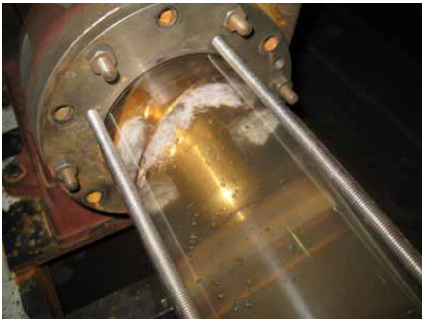
図 6.4.4.9 温水高速新形状 3次元羽根車および TYPE9 組み合わせ可視化 9 (Q=55m 3 /h)
