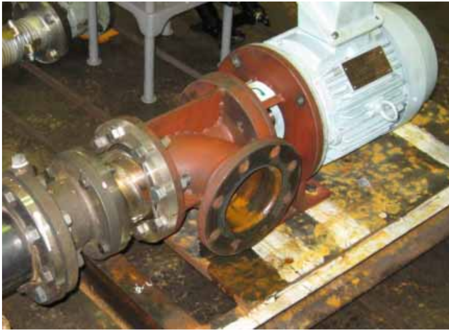
写真 5.2.1 予圧羽根車試験装置全体
