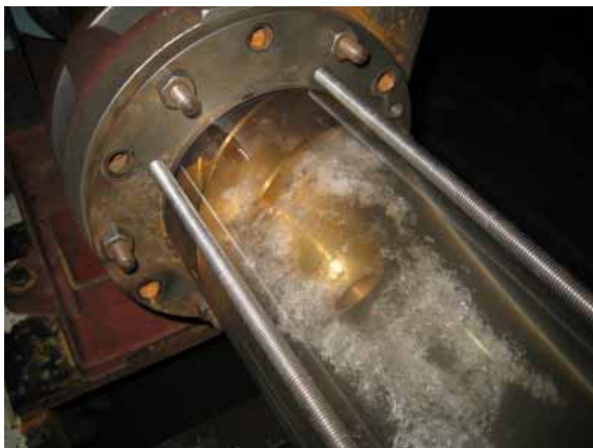
図 6.4.4.2 温水高速新形状 3 次元羽根車および TYPE9 組み合わせ可視化 2 ( Q=15\text{m}^3/\text{h} )
