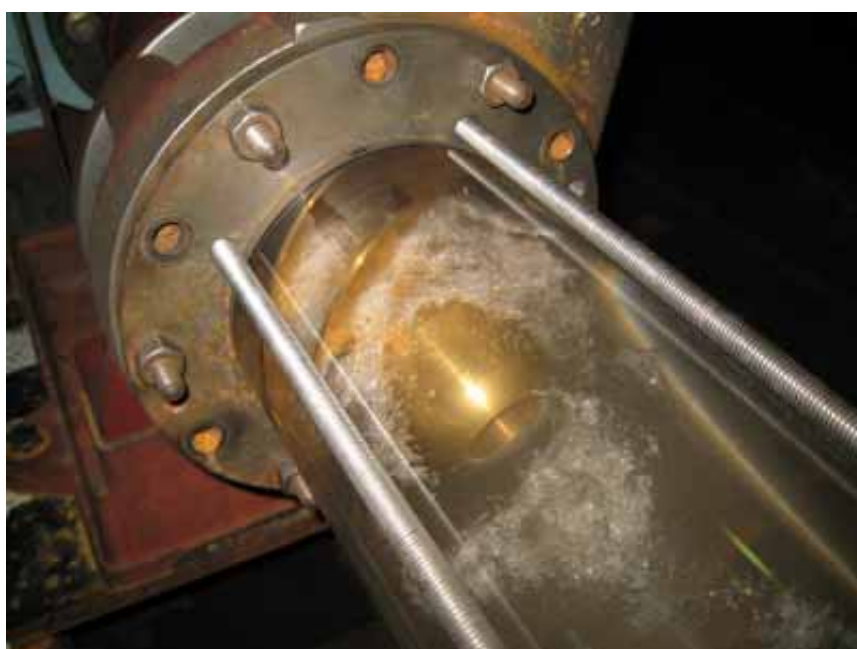
図 6.4.4.6 温水高速新形状 3次元羽根車および TYPE9 組み合わせ可視化 6 ( Q=30\text{m}^3/\text{h} )
