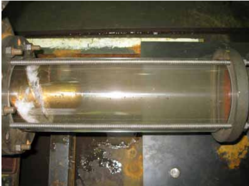
図 6.4.4.11 温水高速新形状 3次元羽根車および TYPE9 組み合わせ可視化 11 ( Q=65\text{m}^3/\text{h} )
