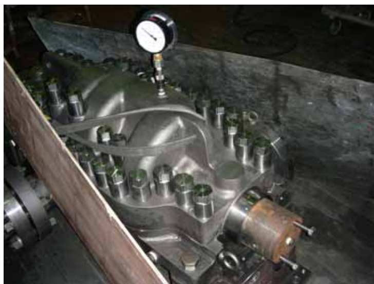
写真 9 . 水圧試験中のポリウレタンケーシング
