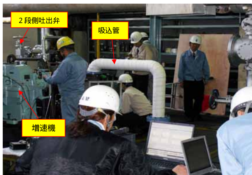
写真12．性能試験中の給水ポンプ用増速機
