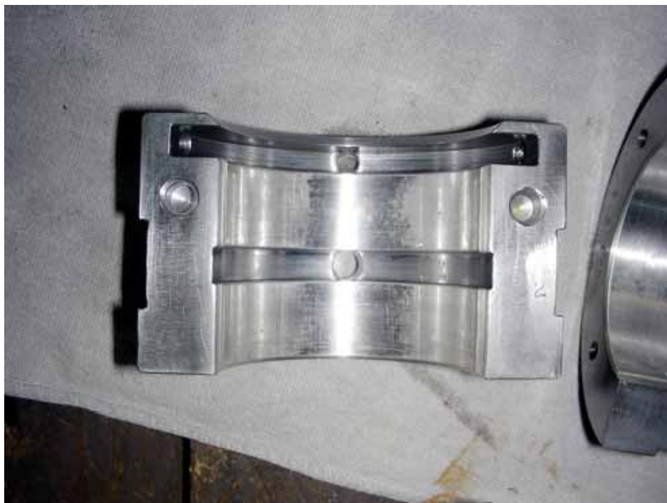
写真 2 1. 軸端側ラジアルメタル
