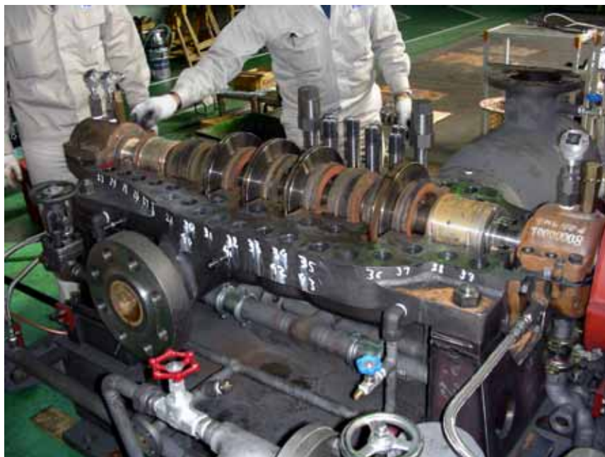
写真15. 下部ポリュートケーシング及びポンプローター
