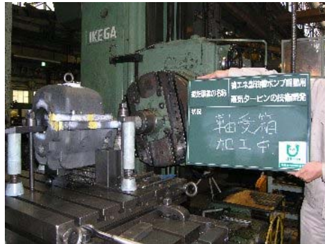
写真 23 軸受箱(加工中)
