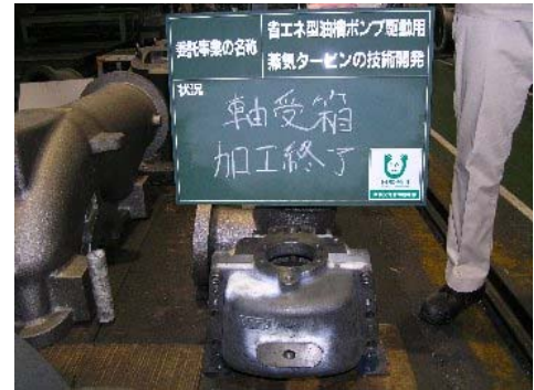
写真 24 軸受箱(加工後)
