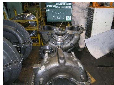
写真 16 タービンケーシング(加工後)
