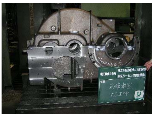
写真 21 減速車室(加工中)
