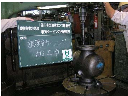
写真 19 調速弁ケーシング (加工中)
