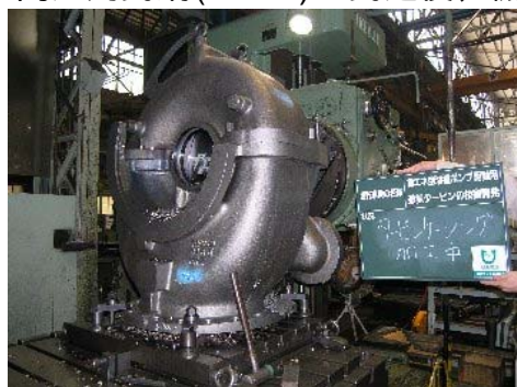
写真 15 タービンケーシング(加工中)
