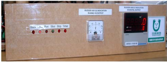
図 35 光学式舵角検出装置試験用作動表示パネル
