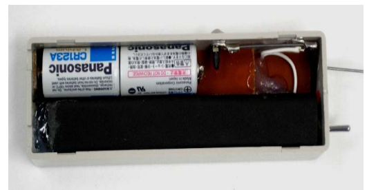
図 33 発信機の開け方と電池交換
