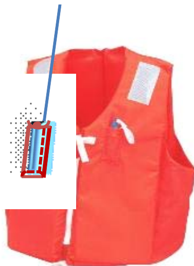
図 17 プロトタイプ発信機の救命胴衣取り付け位置例
