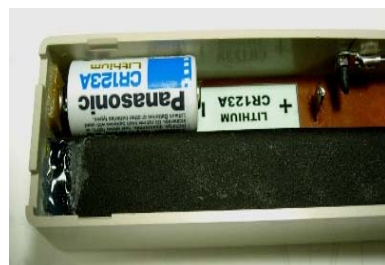
図 33 発信機の開け方と電池交換
