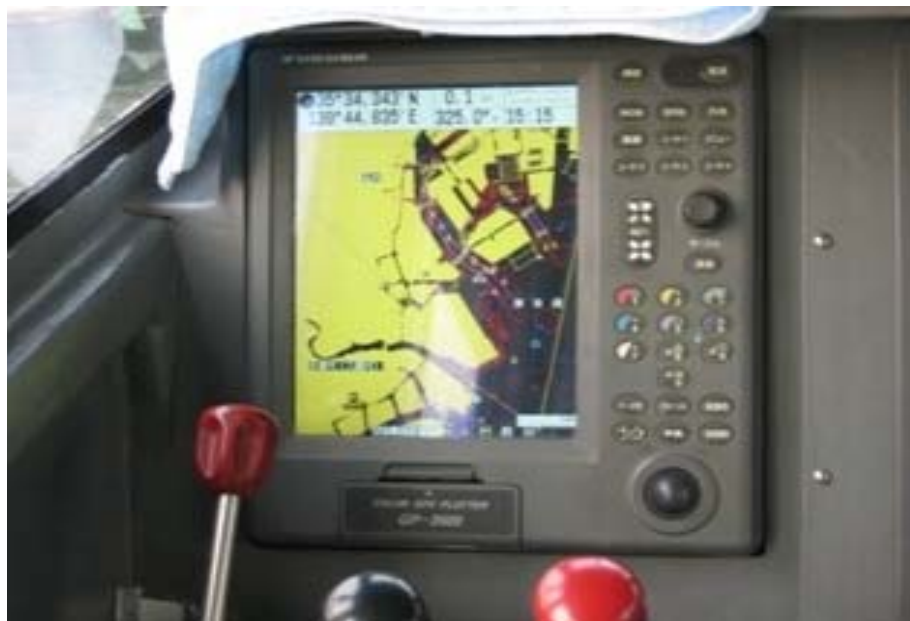
図 25 実用タイプ送受信実験使用のGPS位置測定機
