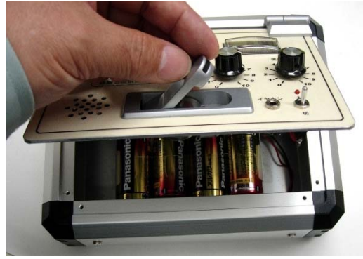
図 34 受信機の開け方と電池交換
