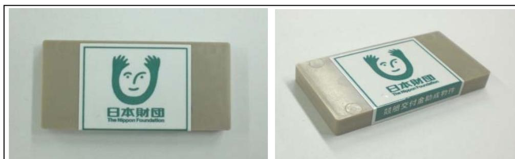
図 3-6 64 キロバイト FRAM 搭載 RFID タグ
