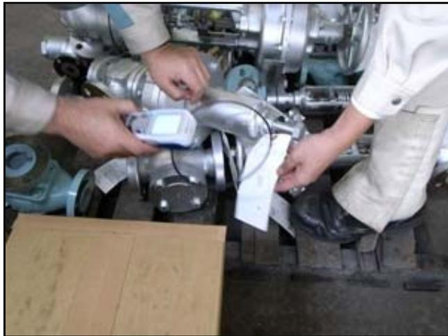
图 2-40 小型製品入荷検品作業（今治造船）
