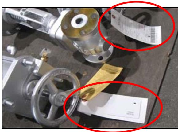
図 2-22 IC タグを貼り付けた製品（中北製作所）
