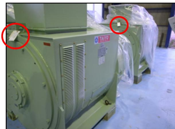
図 2-24 IC タグを貼り付けた製品（大洋電機）
