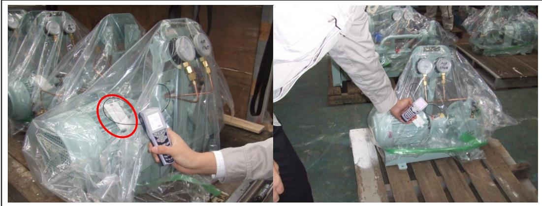
図 3-31 荷降ろしした製品・部品の IC タグ読取
