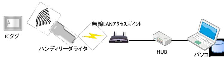
図 1-2 ハンディリーダライタの利用構成例
