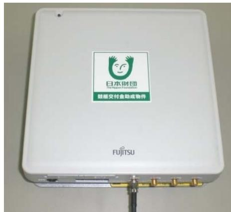
図 3-14 ロングレンジリーダライタ（アンテナ分離型）
