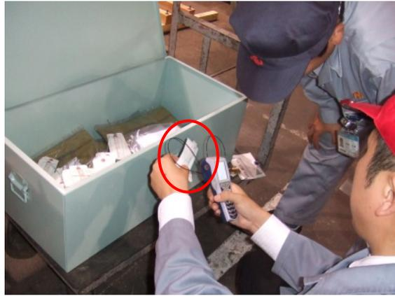
図 3-24 部品梱包箱へ取り付け IC タグへデータを書き込む
