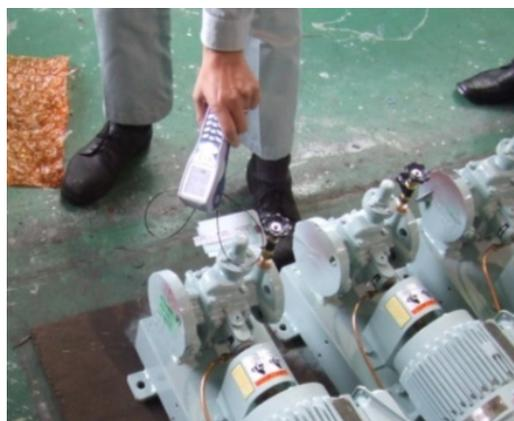
図 3-26 IC タグを読み込む出荷検品作業
