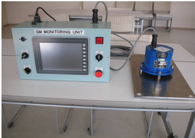
図 3-31 工場にて表示ユニット、動揺センサー動作検証
