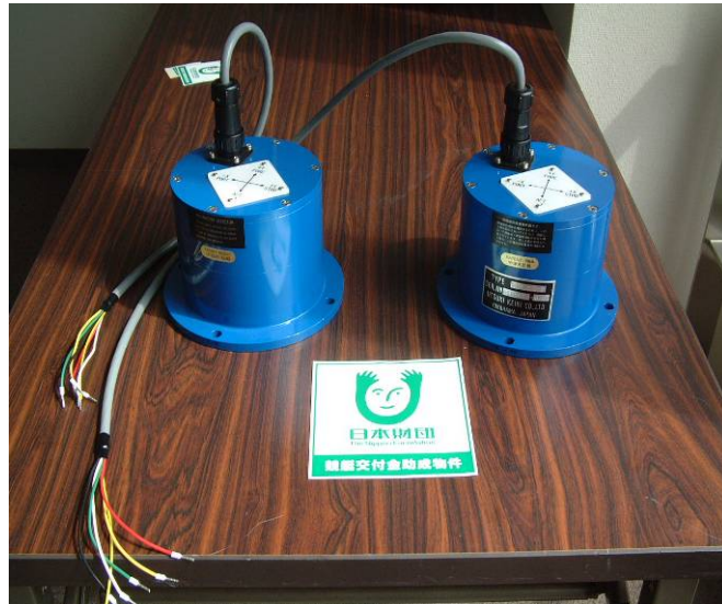
完成した 3 台のうちの 2 台 2 方向高性能動揺センサー
