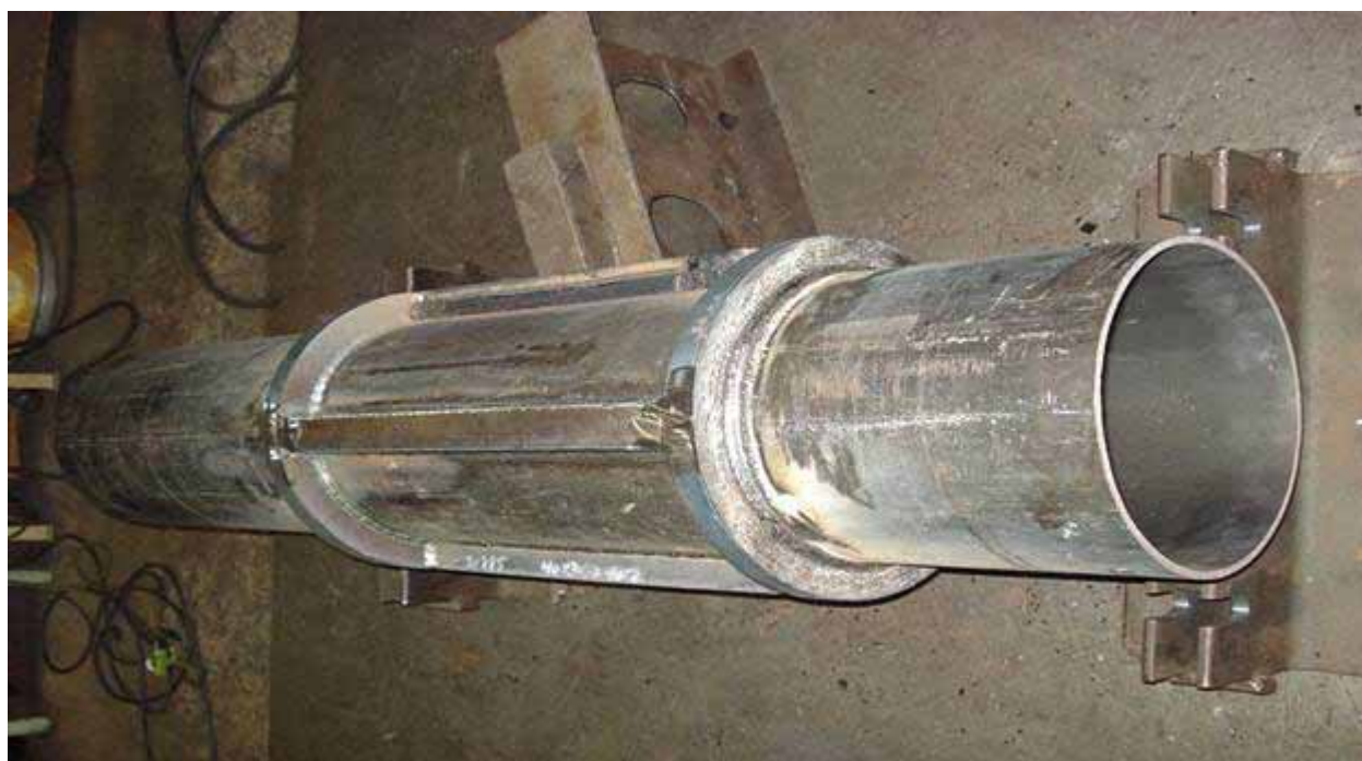
写真 3.2 排気管の外部タンク
