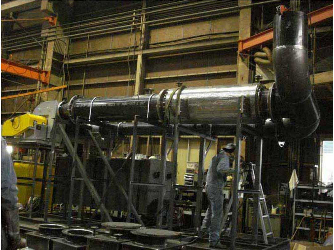
写真 3.7 主機排ガス模擬試験機に煙突を取り付け
