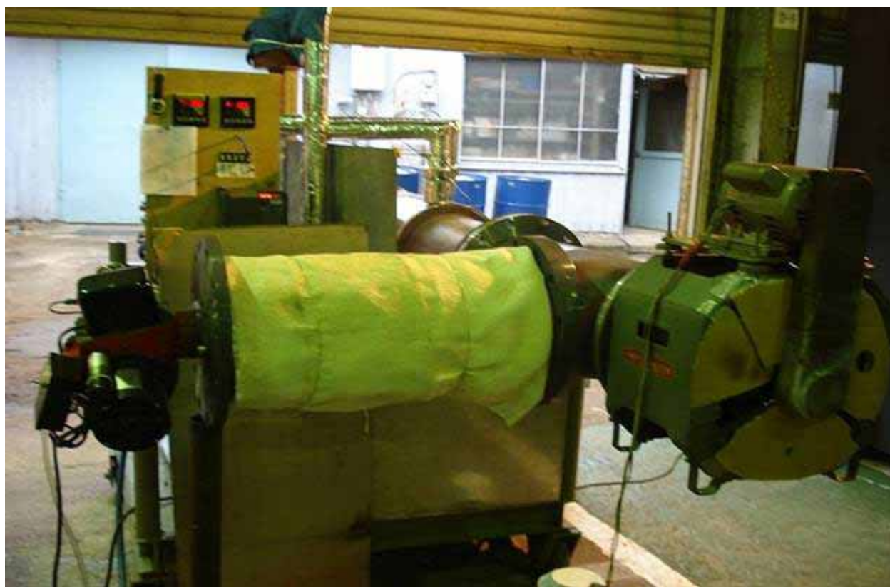
写真 3.5 小型熱交換器燃焼テスト状態
