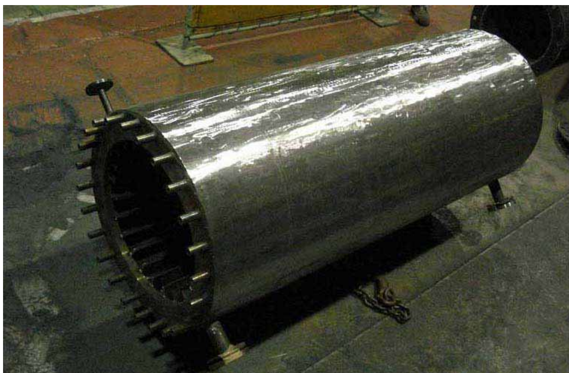
写真 3.3 排ガス熱交換器本体完成
