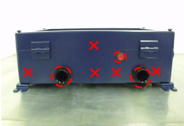
写真 4.4.7-2 静電気放電ポイント箇所
