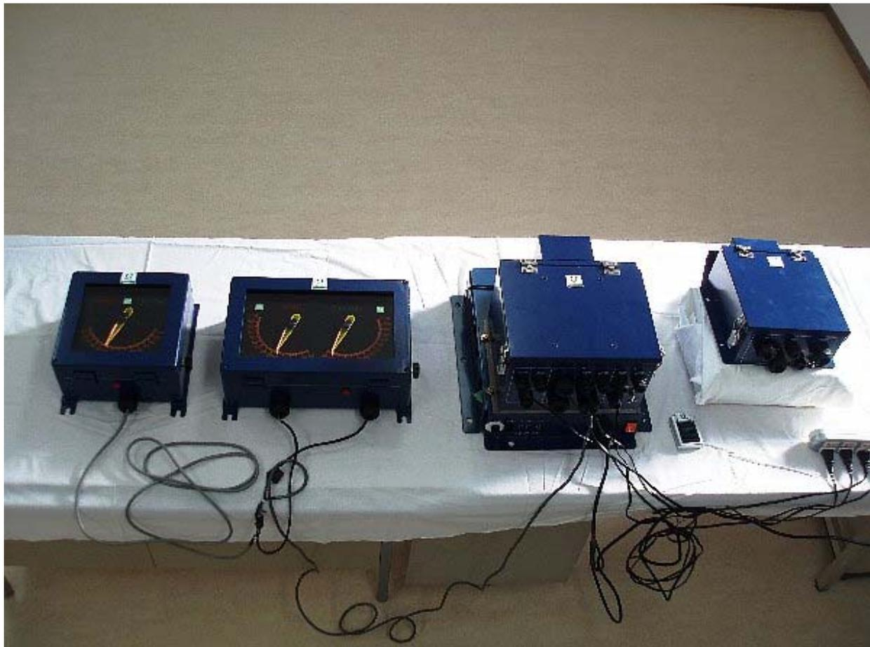
写真 4.2.1-1 操舵システム作動監視装置のアクチュエータ代替駆動装置を用いての作動試験の様子
