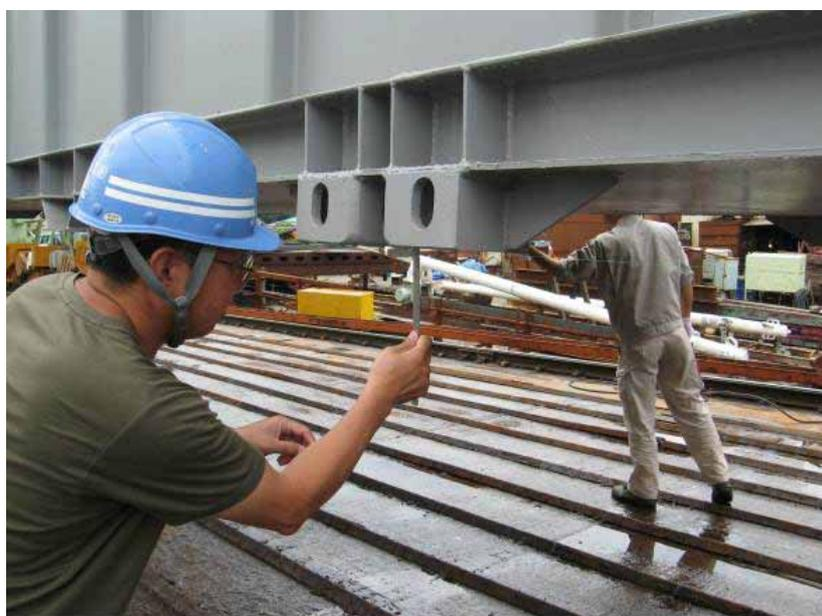
図 3.2.1-3 . 強度（たわみ）試験
