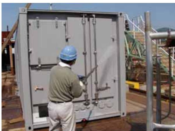
図 3.2.1-1 . 風雨密（射水）試験
