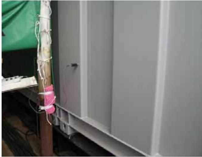
図 3.2.4-3 コンテナ型常用発電機装置外板振動計測
