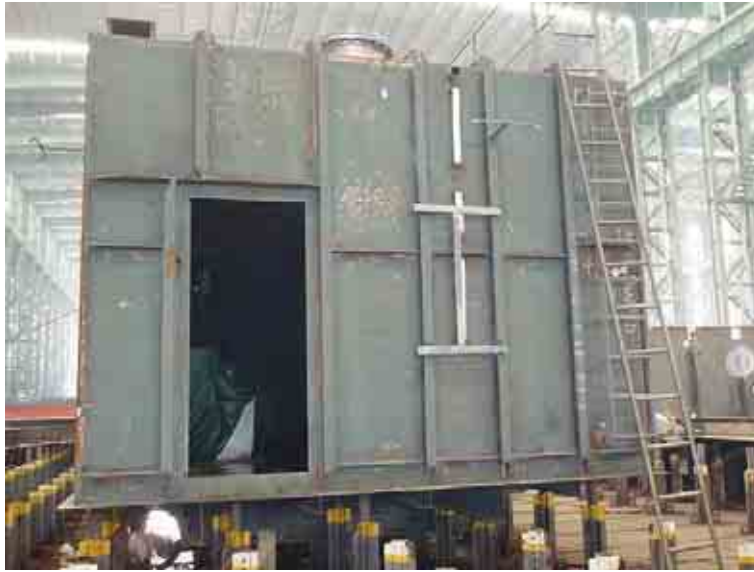
写真 2.8 E造船所（機関制御室ユニット）
