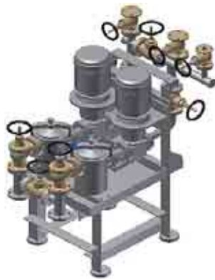
図 4.62 燃料油移送ポンプモジュール
