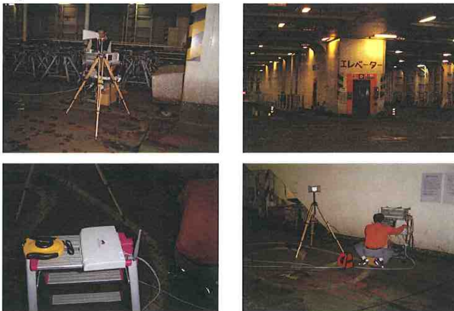
図10 車両甲板での電界強度測定の様子
