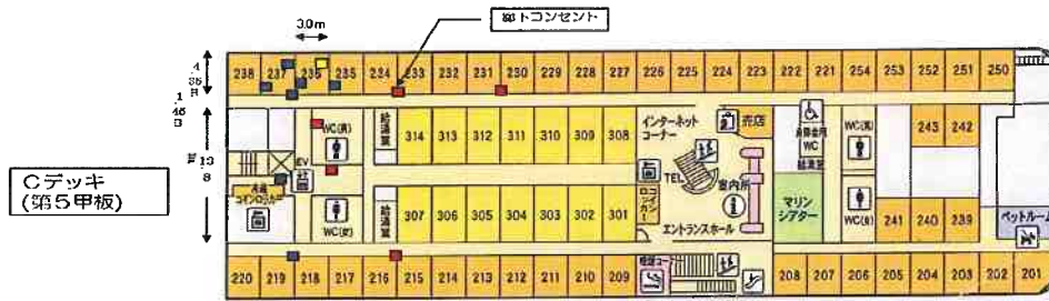
図 9 236号室コンセント(黄色)と各コンセントとの通信可否(青色=可能, 赤色=不能)
