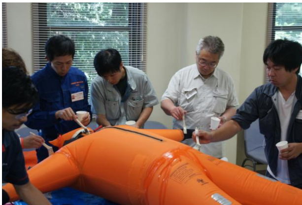
破孔の有無をチェックする気密試験
