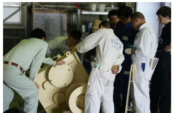
ウインチの分解・点検・整備
