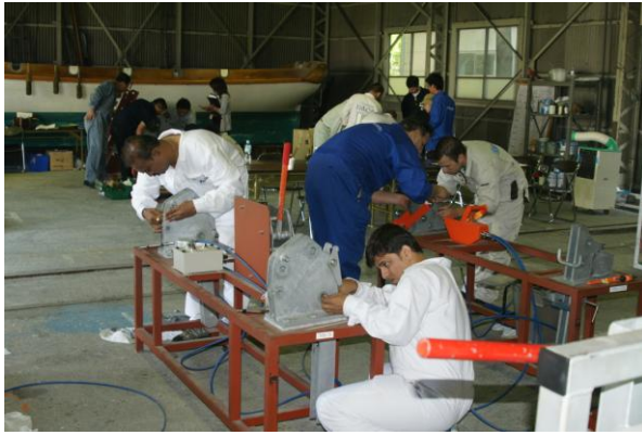
離脱フックの分解・点検・整備
