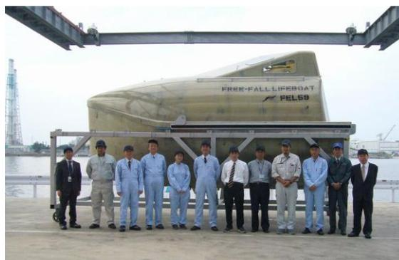
実証、評価しながら新船型を開発し、また落下時の姿勢安定化方策について検証した結果、条件の厳しい少数化に対応した救命艇（25名定員）でありながら、従来艇（30名定員）よりも、乗員に加わる加速度を評価する変位評価係数を低減させることができ、目標を達成できた。今回の開発成果をもとに製品化を図れば、国際マーケットにおいても十分に競争力を有する高性能な自由降下式救命艇を製造することができると思われる。
