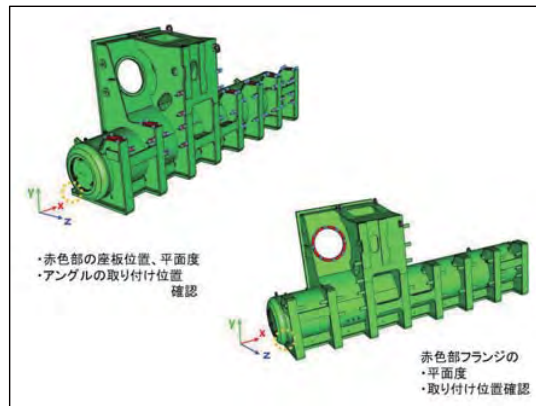
- 組立時に精度が必要なため計測している箇所 -
