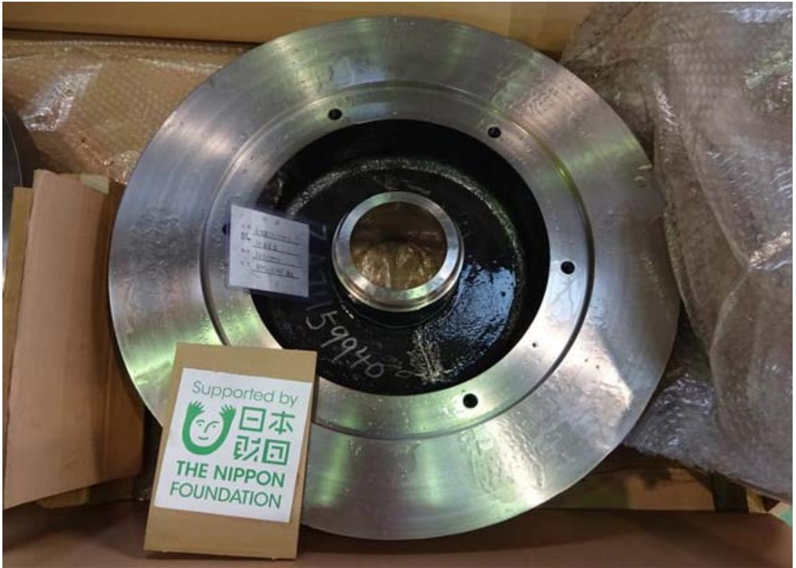
図 25 バックライナー（高クロム鋳鉄使用）
