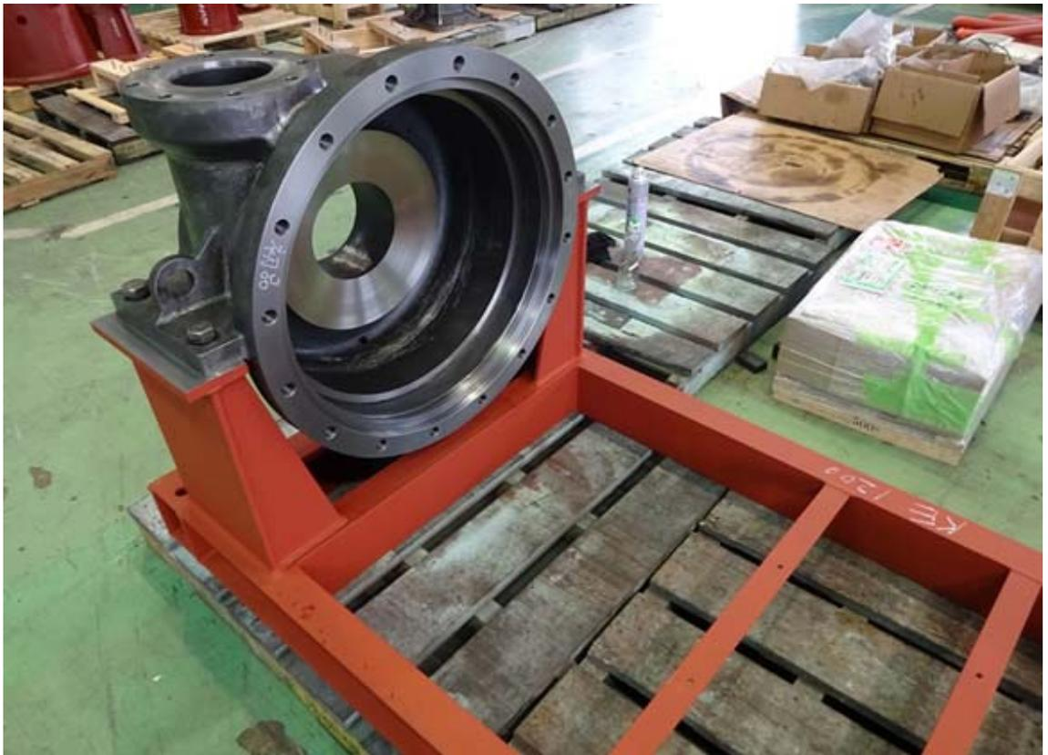
図 37 二重ケーシング（反駆動側）の共通台板への据付
