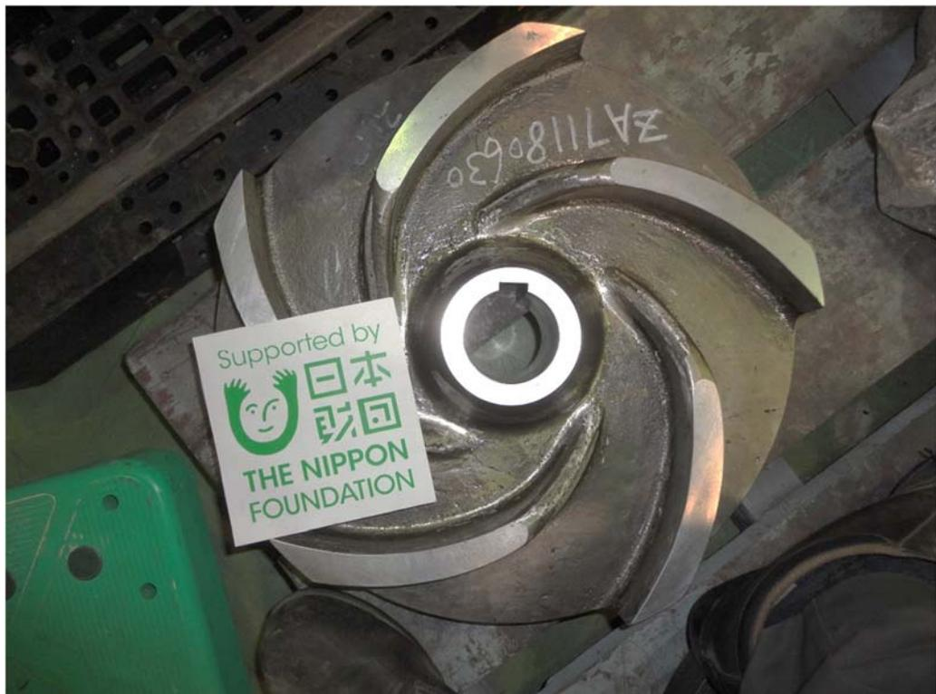
図 88 II 試作ポンプインペラ（高クロム鋳鉄使用）
