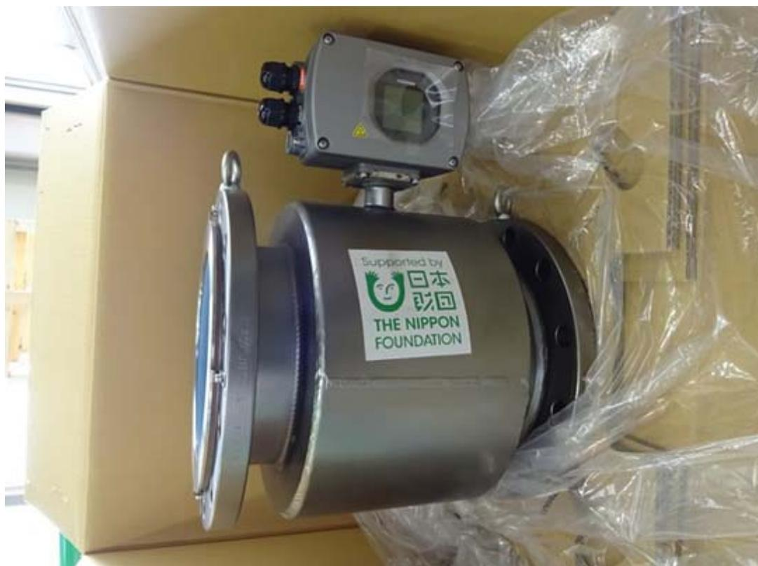
図 45 電磁流量計
