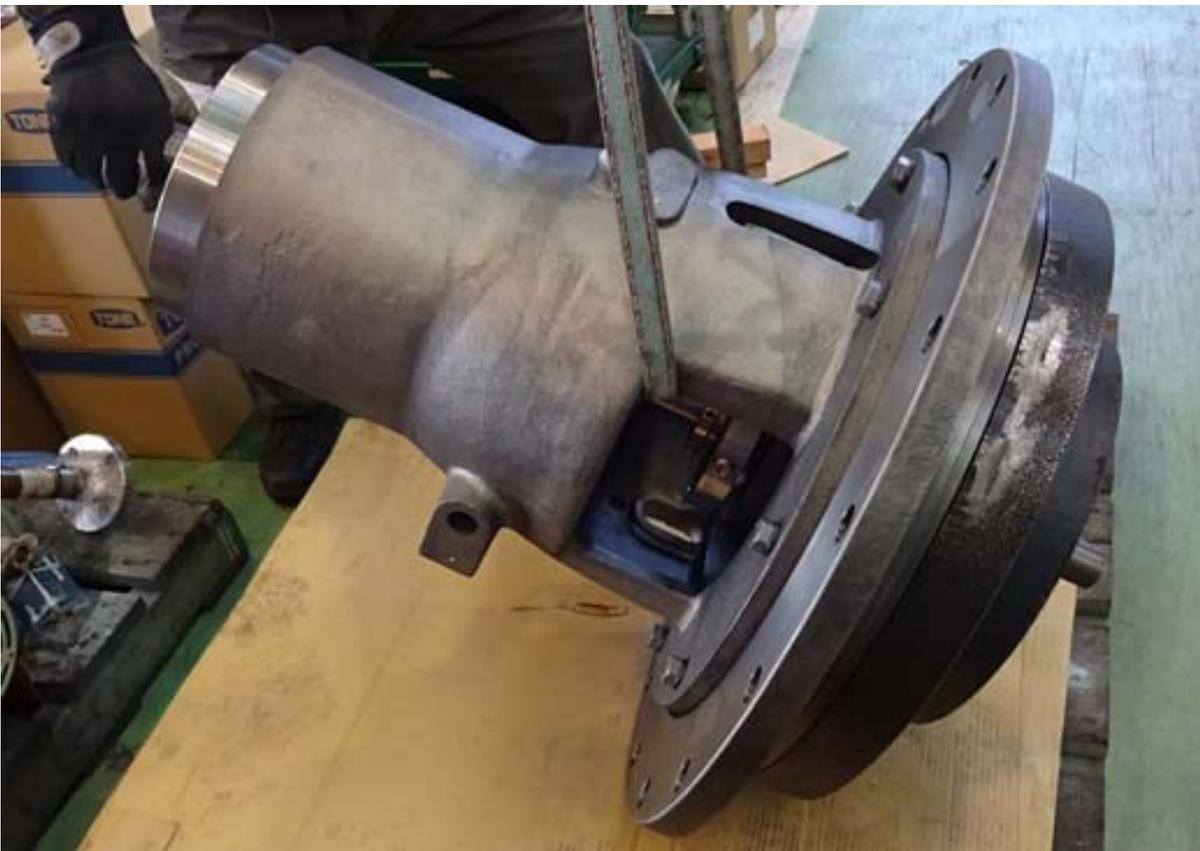
図 35 シャフト、軸受、軸封部および二重ケーシング（駆動側）の組立て
