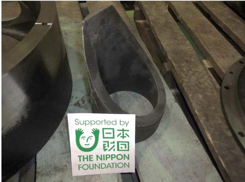
図 87 吐出しノズルスリーブ（高クロム鋳鉄使用）
