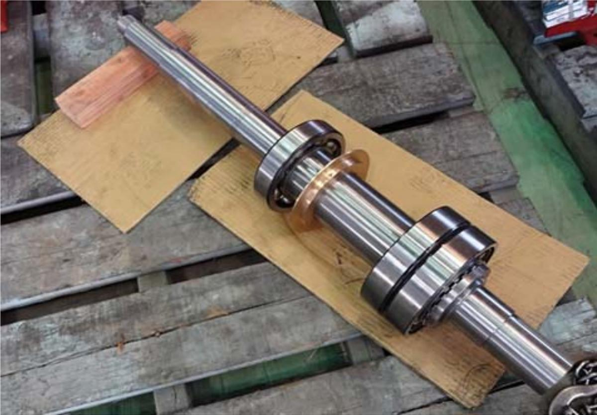
図 34 シャフトおよび軸受ベアリング
