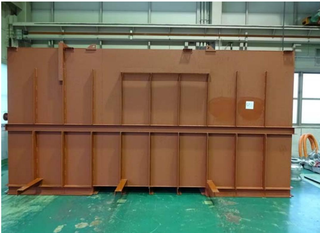
図 44 試験用タンク（容量 20m<sup>3</sup>、防錆塗装した SS400 使用）
