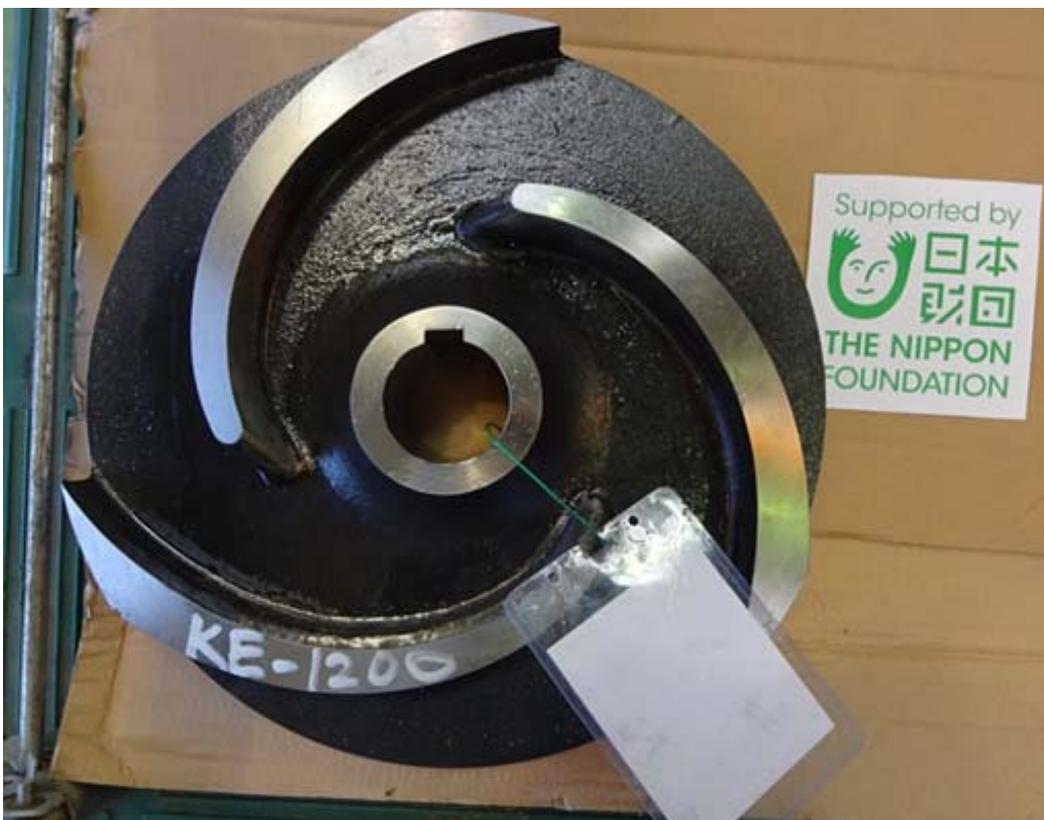
図 28 3枚羽根インペラ（高クロム鋳鉄使用）
