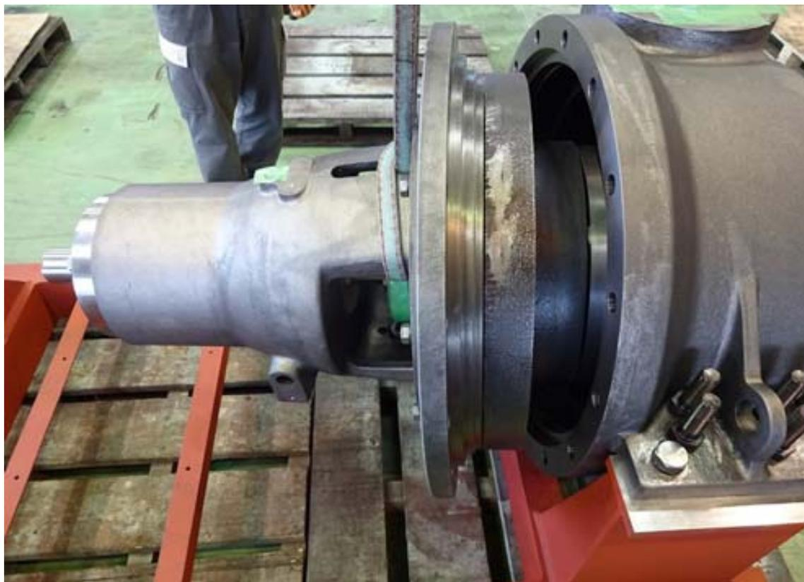
図 38 軸封部側構成部品とケーシング構成部品の組立ての様子
