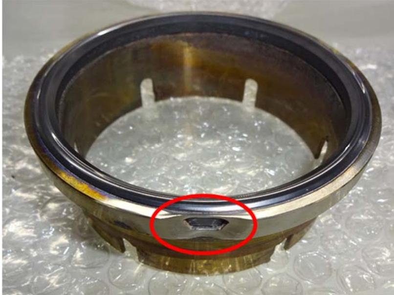
図 114 シールリングの破孔部
