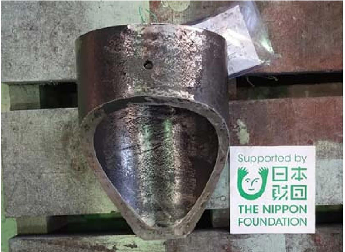
図 29 吐出しノズルスリーブ（高クロム鋳鉄使用）
